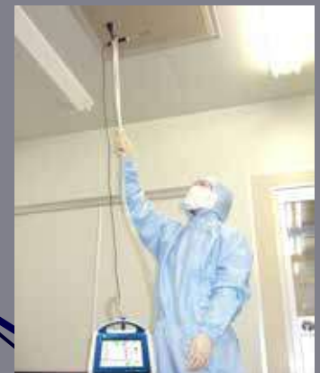
Sonda para Climomaster para medidas ambientales
