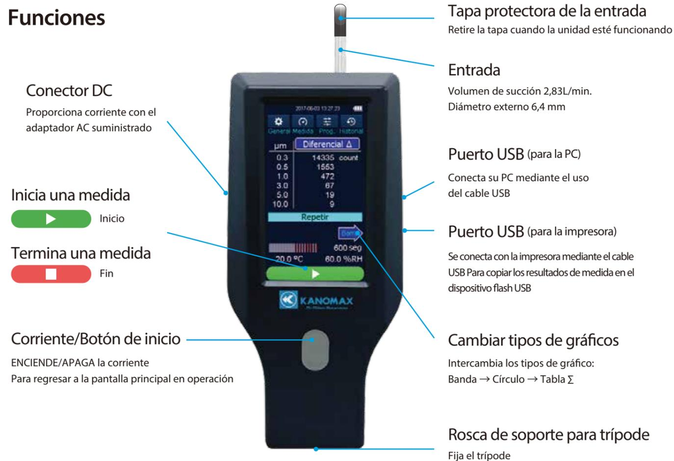
**Nota:** No cubra ni introduzca nada en el orificio de escape roscado situado en la parte posterior del instrumento
